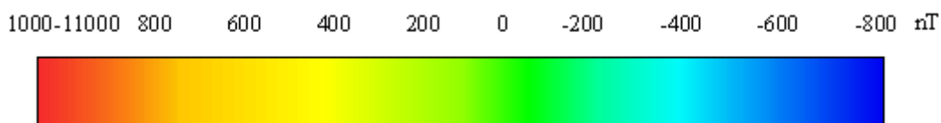
Joonis 29. Aeromagnetiliste anomaaliade kaardi magnetvälja intensiivsust väljendav värviskaala
