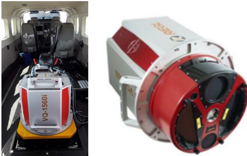
Joonis 10. Maa-ameti kasutatav laserskanner RIEGL VQ-1560i. Allikas: Maa-amet
