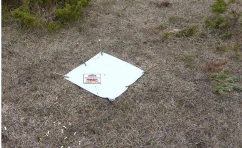
Joonis 4. Maastikule paigaldatud 60 x 60 cm kileruut geodeetilise punkti markeerimiseks. Allikas: Maa-amet
