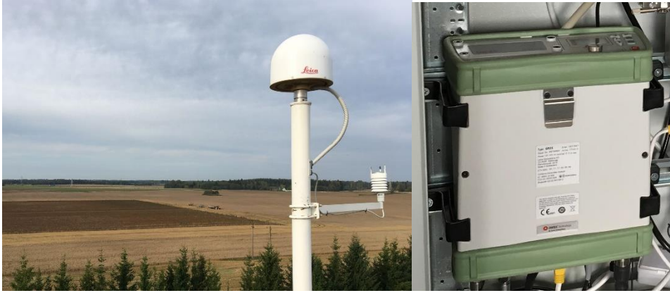
Joonis 16. GNSS-antenn koos antennisambaga ning GNSS-vastuvõtja. Allikas: Maa-amet
