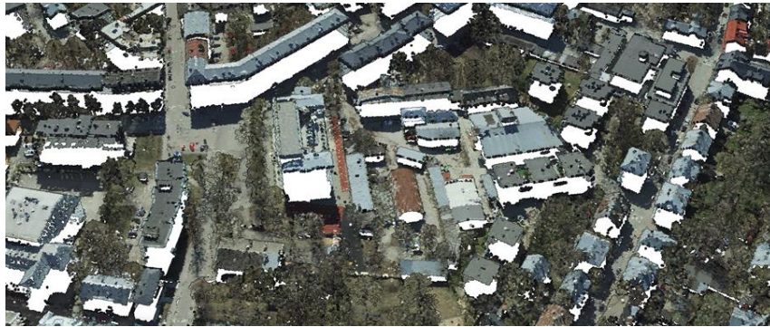
Joonis 11. Maa-ameti lennukilt aerolaserskaneerimise teel saadud tihe koloreeritud punktipilv (589541_2020_tava). Andmestikus puuduvad vertikaalsete pindade, fassaadi punktid. Allikas: Maa-ameti geoportaal, aerolaserskaneerimise kõrguspunktid 5
