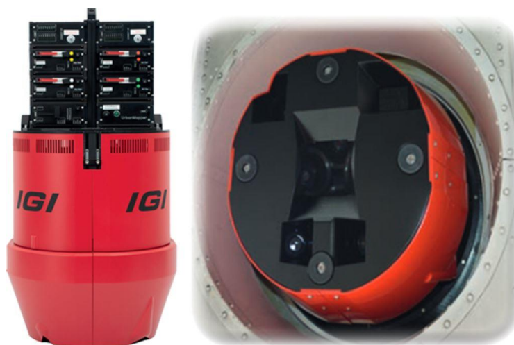
Joonis 39. IGI UrbanMapper-2 Performance'i kaamerasüsteem. Allikas: IGI Systems 48
