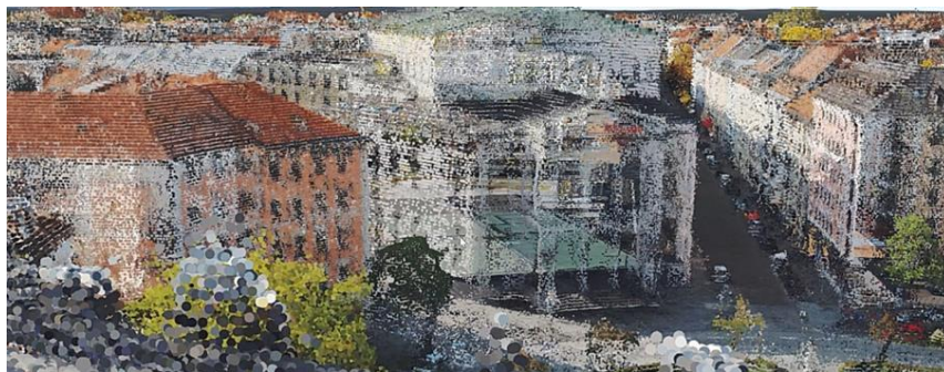
Joonis 13. Müncheneri linnamudeli kaldaerofotodelt tuletatud punktipilv, mis on genereeritud kasutades Leica CityMapper-2 kaamera pilte ja sisaldab nii pealtvaate kui ka vertikaalsete pindade punkte. Allikas: Müncheneri 3D näidis 7
