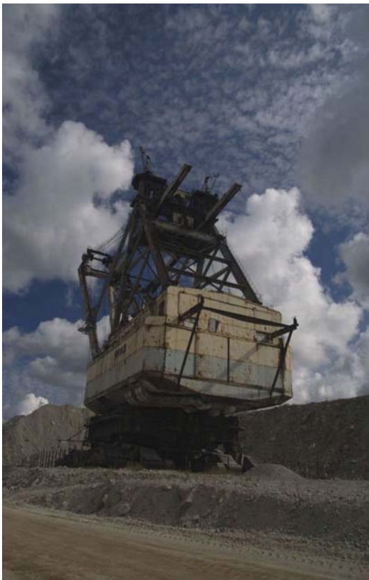
Foto 79. Esku ehk mehaaniline labidas EŠ 35/65 oli kunagi (tänapäevaks on ta lammutatud) omasuguste seas maailma suurim.
