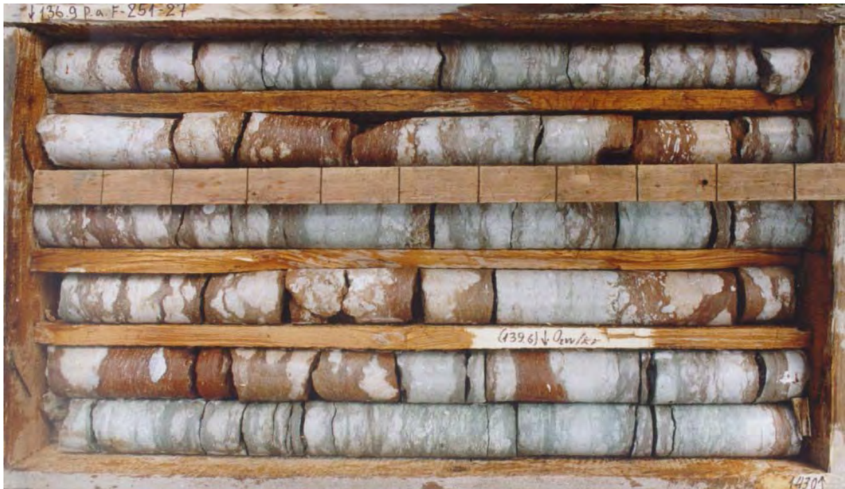
Foto 1.16. Viivikonna kihistu Kiviõli kihistiku kukersiidi kihid A–H. Puurauk F251 (Kadila) Photo 1.16. The Viivikonna Formation Kiviõli Member with the kukersite beds A–H. The well F251 (Kadila)
