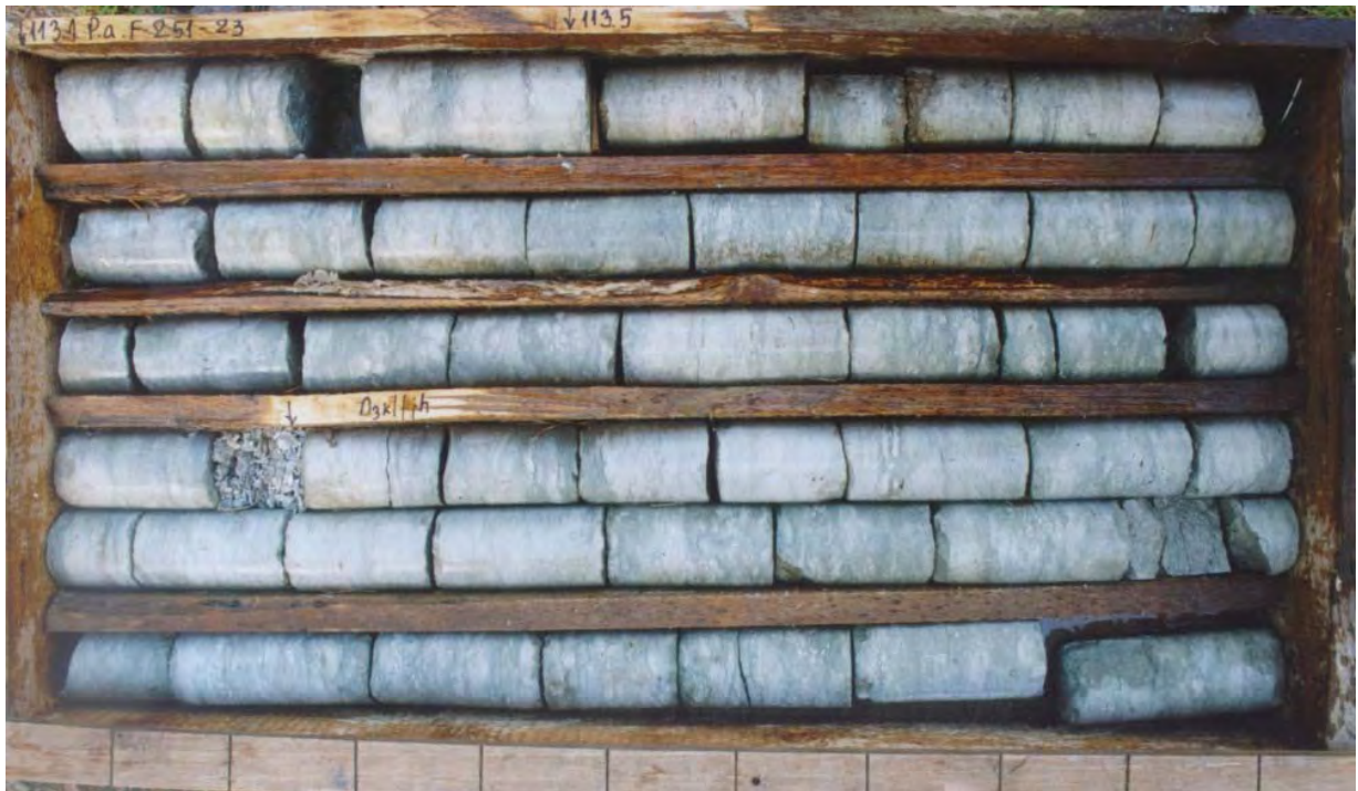
Foto 1.18. Kahula kihistu savikad lubjakivid. Sügavusel 116,2 m K-bentoniit. Puurauk F251 (Kadila) Photo 1.18. The argillaceous limestones of the Kahula Formation. In the depth 116,2 m K-bentonite. The well F251 (Kadila)
