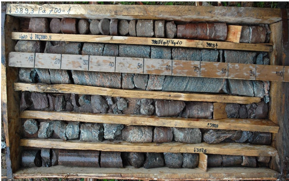
Foto 1.1. Ediacara liivakivid-aleuoliidid (ülal) ja kristalse aluskorra Tapa ploki biotiit-amfiboolgneissid (all) puuraugust 700 (Oostriku).
