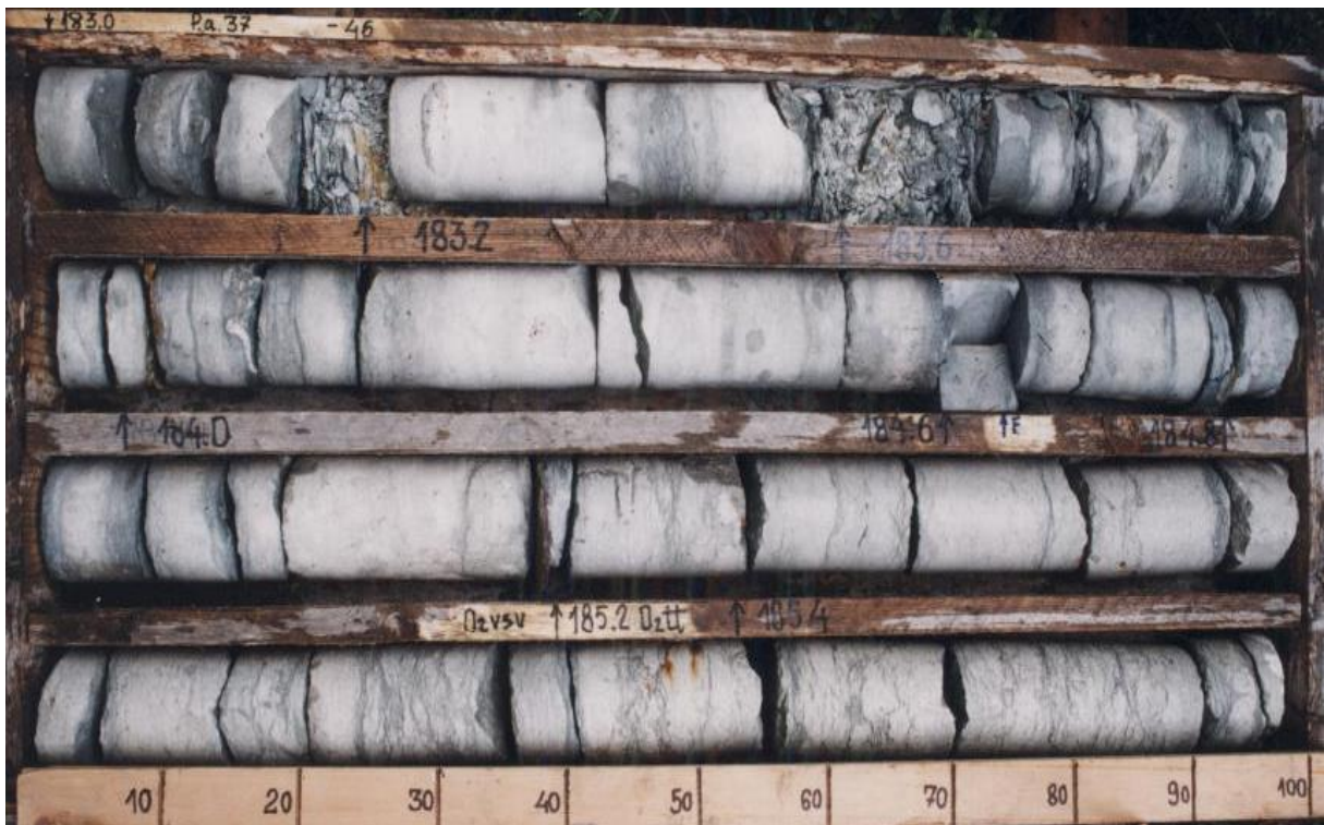
Foto 1.14. Tatruse kihistu (all) ja Vasavere kihistik lubjakivi (ülal) puuraugust 37 (Oostriku). Süg. 183,6 m Kinnekulle K-bentoniit. Photo 1.14. Limestones of the Tatruse Formation (below) and Vasavere Member in the borehole 37 (Oostriku). In the depth 183,6 m Kinnekulle K-bentonite.
