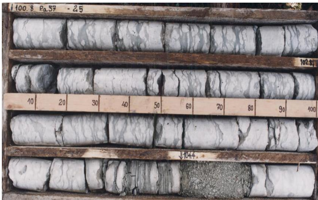
Foto 1.23. K-bentoniit (104,4 m) Moe kihistu (Pirgu lade) lubjakivis puuraugus 37 (Oostriku). Photo 1.23. K-bentonite (104,4 m) in the limestone of the Moe Formation (Pirgu Stage) in the borehole 37 (Oostriku).
