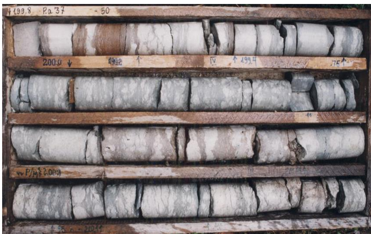
Foto 1.12. Viivikonna kihistu. Peetri kihistik (ülal) ja Maidla kihistik (all) puuraugust 37 (Oostriku). Photo 1.12. Viivikonna Formation. Peetri Member (above) and Maidla Member (below) in the borehole 37 (Oostriku).
