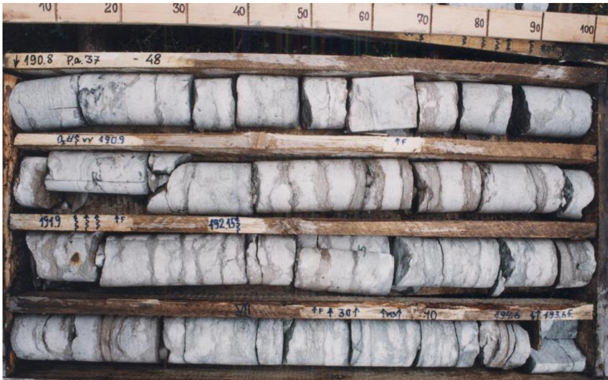
Foto 1.13. Viivikonna ja Tatruse kihistu. Kihistute vaheline piir (190,9 m) puuraugust 37 (Oostriku). Photo 1.13. The boundary between formations (190,9 m) in the borehole 37 (Oostriku).
