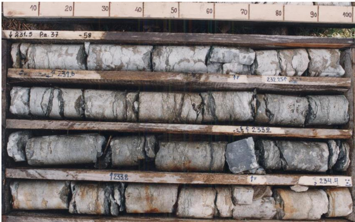
Foto 1.7. Loobu kihistu lubjakivi puuraugust 37 (Oostriku). Photo 1.7. Limestones of the Loobu Formation in the borehole 37 (Oostriku).
