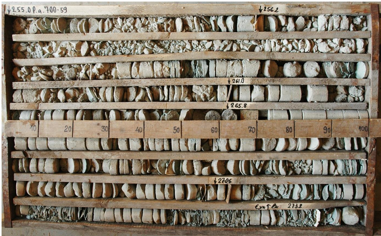
Foto 1.4. Vaki kihistu kvartsliaivakivi puuraugust 700 (Oostriku). Photo 1.4. Quartz sandstone of the Vaki Formation in the borehole 700 (Oostriku).
