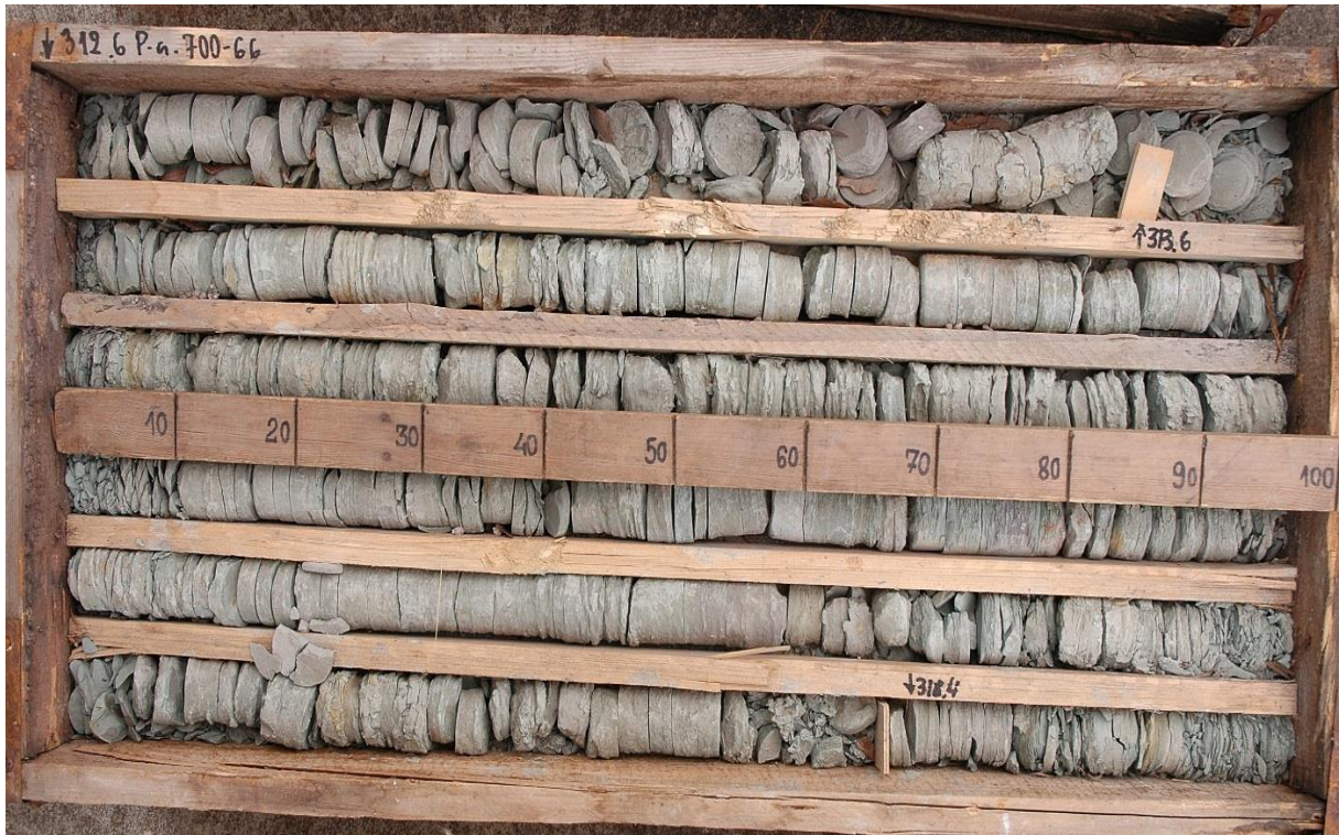
Foto 1.3. Lontova kihistu aleuriitne savi (sinisavi) puuraugust 700 (Oostriku). Photo 1.3. Aleuritic clay (blue clay) in the borehole 700 (Oostriku).
