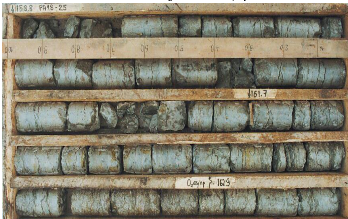
Foto 1.3. Kandle kihistu (Aseri) lubjakivi Anna puuraugu läbilõikes Photo 1.3. Limestone of the Kandle Formation (Aseri Stage) in the Anna drill core
