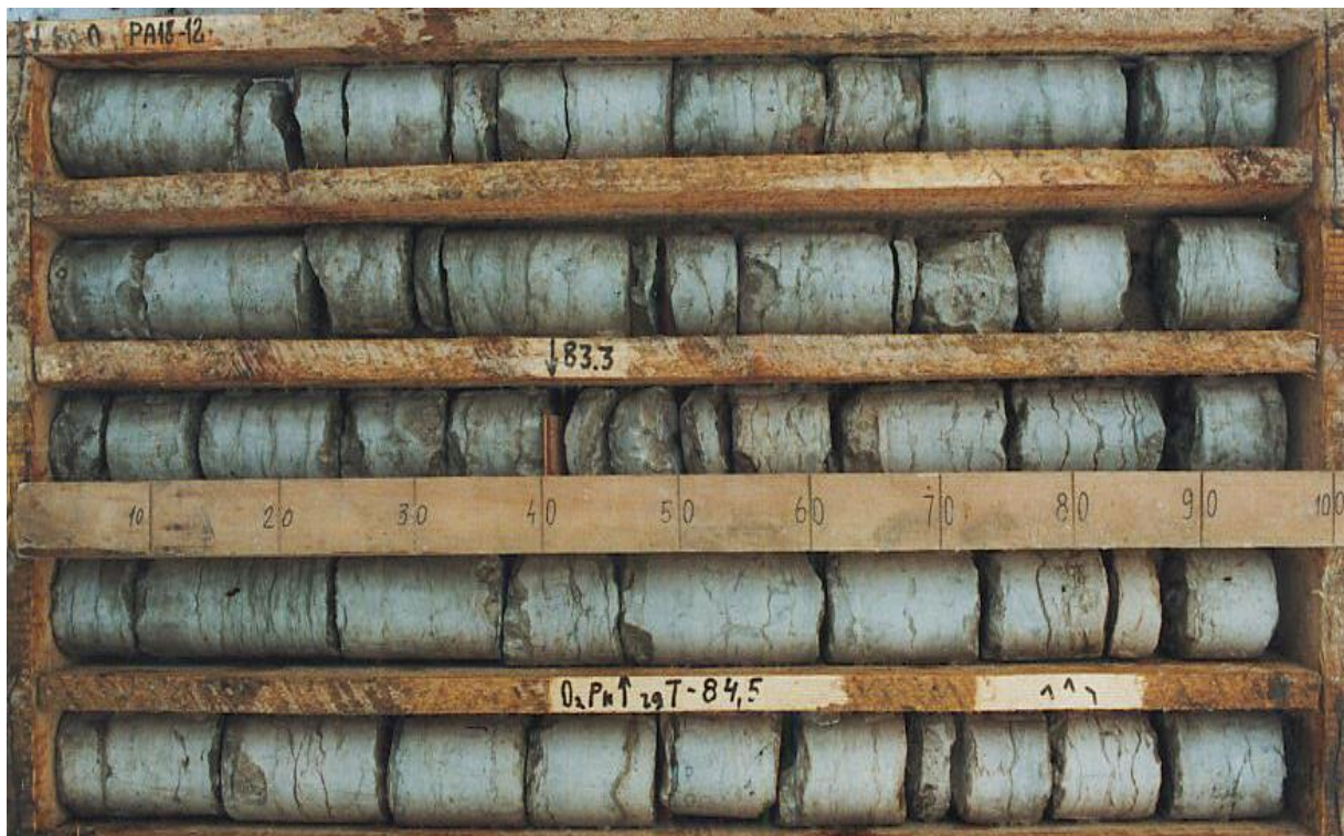
Foto 1.13. Paekna kihistu (Nabala lade) lubjakivi (ülal) ja Rägavere kihistu (Rakvere lade) lubjakivi (all) Anna puuraugu läbilõikes Photo 1.13. The limestone of the Paekna Formation (Nabala Stage) – on the top, and limestone of the Rägavere Formation (Rakvere Stage) – below, in the Anna drill core
