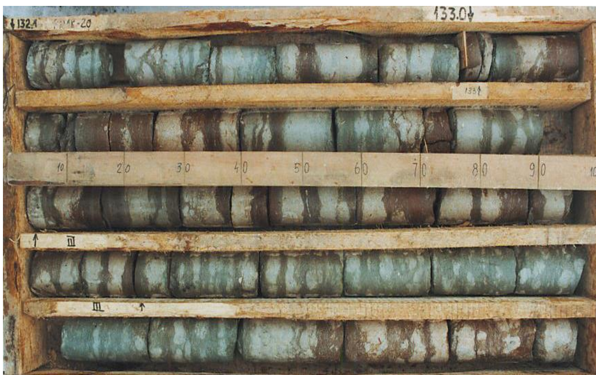
Foto 1.7. Viivikonna kihistu (Kukruse lade) kukersiiti (õil shale) sisaldavad kihid Anna puuraugu läbilõikes Photo 1.7. The kukersite (oil shale) bearing beds of the Viivikonna Formation (Kukruse Stage) in the Anna drill core
