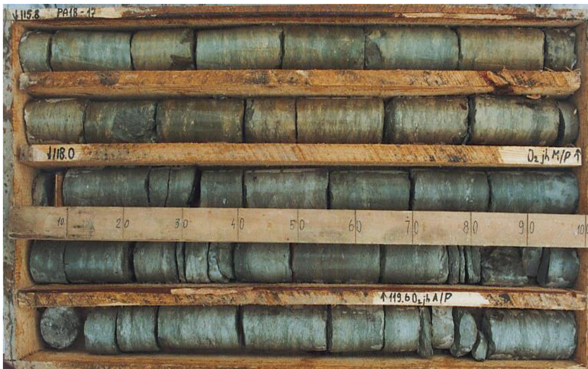
Foto 1.10. Kahula kihistu (Idavere alamlade) savikas lubjakivi ja mergel Anna puuraugu läbilõikes Photo 1.10. Argillaceous limestone and marl of the Kahula Formation (Idavere Substage) in the Anna drill core
