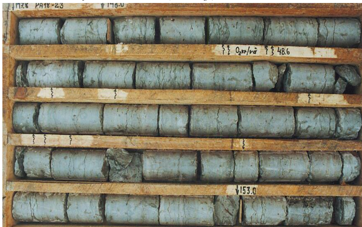
Foto 1.4. Vão kihistu (Lasnamäe lade) lubjakivi Anna puuraugu läbilõikes Photo 1.4. Limestone of the Vão Formation (Lasnamäe Stage) in the Anna drill core
